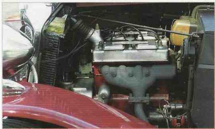
De zeer compacte Nine motor met z'n twee nokkenassen, twee S.U.'s, en z'n (maar) twee hoofdligers.
