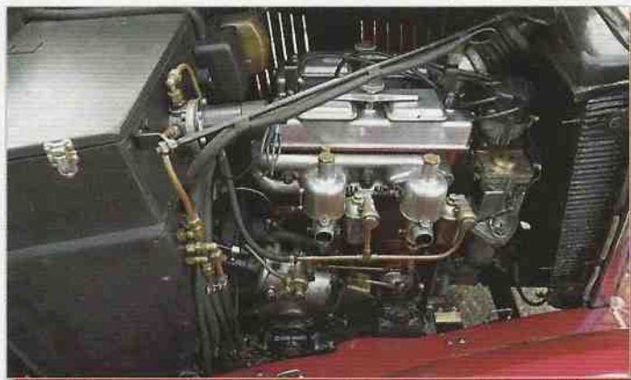
De zeer compacte Nine motor met z'n twee nokkenassen, twee S.U.'s, en z'n (maar) twee hoofdligers.
