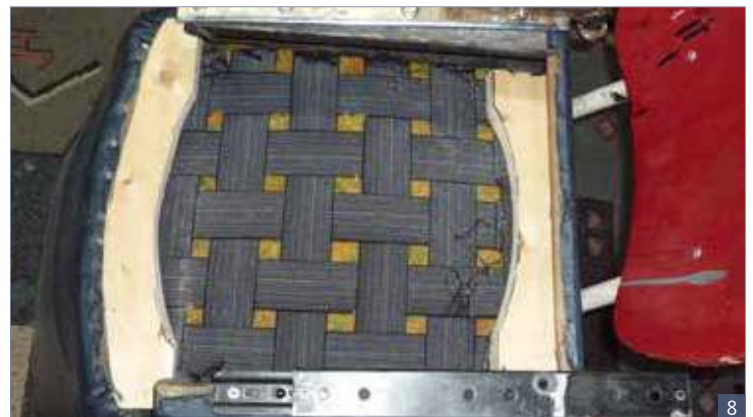
8 Zo komen de afstand stukjes er in. Dan weer extra vulling en de bodem-plaat kan ook hier er overheen geschroefd worden.
