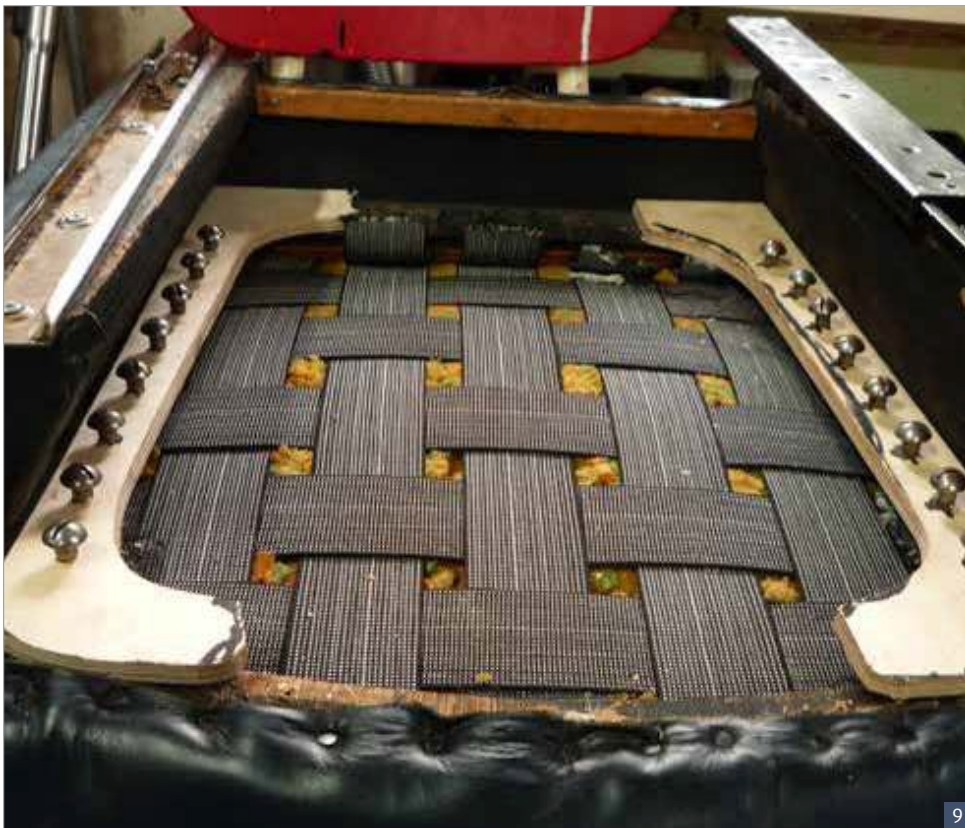
9 Een nieuwe poging. Nu om er extra elastieken onder te krijgen. Ik maak strips met grote schroeven om elastieken aan vast te zetten.
