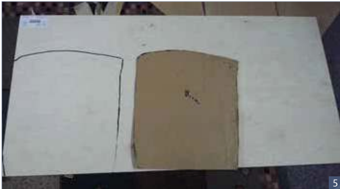
5 Mal overbrengen op stevig triplex en uitzagen.
