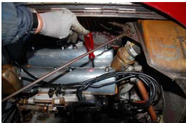
Met een schroevendraaier in het bougiegat zoek ik het bovenste dode punt op
