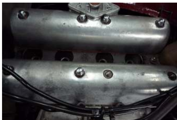
Dubbele nokkenassen, dus ook twee kleppendeksels
