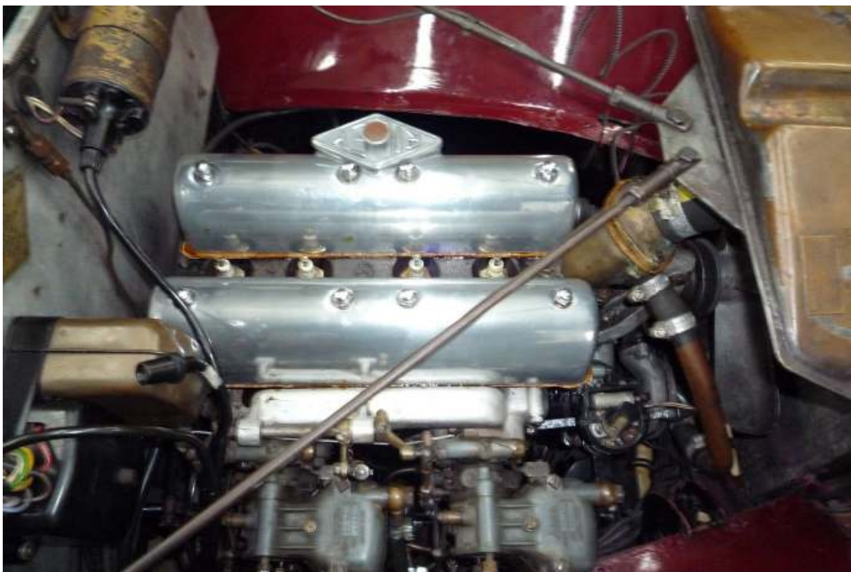
Ook de bovenkant van de pakking in de vloeibare pakking. Dan kan het deksel er op.
