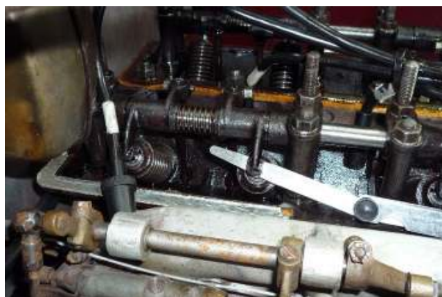
Klepspel meten met een voelmaat. 0,003 inch (0.1mm) is maar heel weinig dus het moet echt goed staan.
