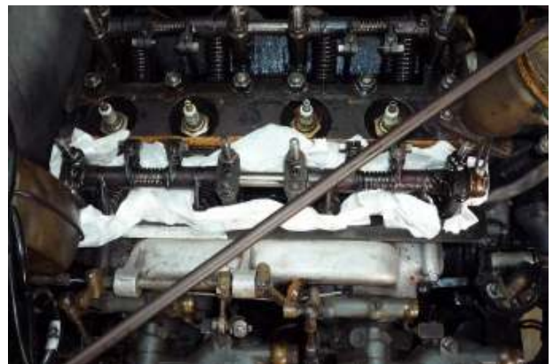
De bougies er weer in en alles verder inpakken met papier om te voorkomen dat er troep in het kleppenhuis valt. Dan met een platte beitel de pakkingsresten verder weghalen.
