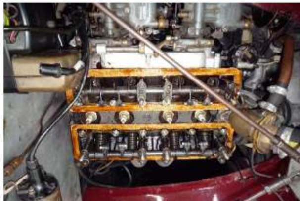
Ook de bovenkant van de pakking in de vloeibare pakking. Dan kan het deksel er op.
