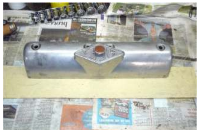
Op een glasplaat met schuurpapier voorzichtig heen en weer schuiven.
