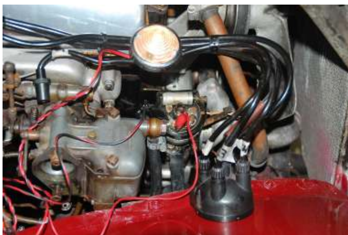
Ontsteking afstellen met behulp van een proeflampje
