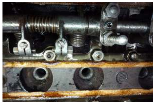
Hier kun je zien hoe de stelbout geborgd wordt: hij wordt vastgeklemd in de tuimelaar.
