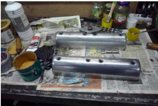
Met behulp van Commandant en veel "elbow grease" worden de deksels gepolijst.
