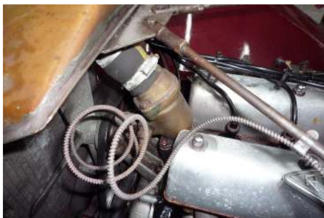
Hier zit de thermostaat, in dit bronzen huis. Het is duidelijk dat je er alleen bij kan als de radiator naar voren kantelt.
