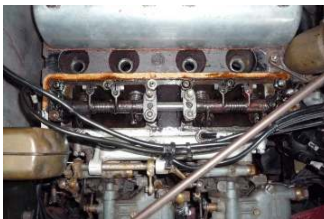
Een deksel is eraf, de pakking wordt kapot getrokken en blijft gedeeltelijk zitten.
