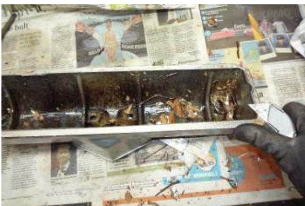
Met een mes de oude pakking van het deksel schrappen. Voorzichtig, want je maakt zo een groef in het zachte aluminium.
