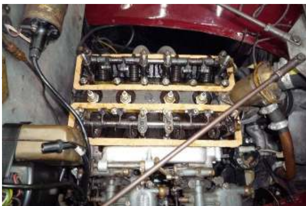
Pakkingen passen. Cilinderkop met vloeibare pakking insmeren en pakking erop.
