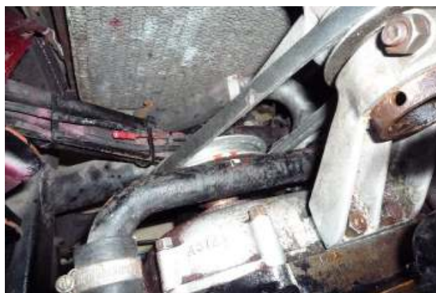
1De merktekens op de poelie,. Rechts die voor 7 graden voor-ontsteking en links die van de 5 graden na-ontsteking.
