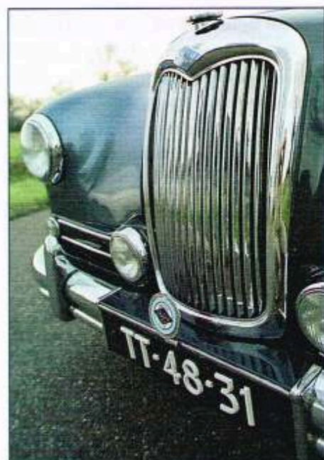
De radiateurdop is nep, maar heeft toch een functie: hij dient nu als bedieningsknop voor de motorkapvanger.
